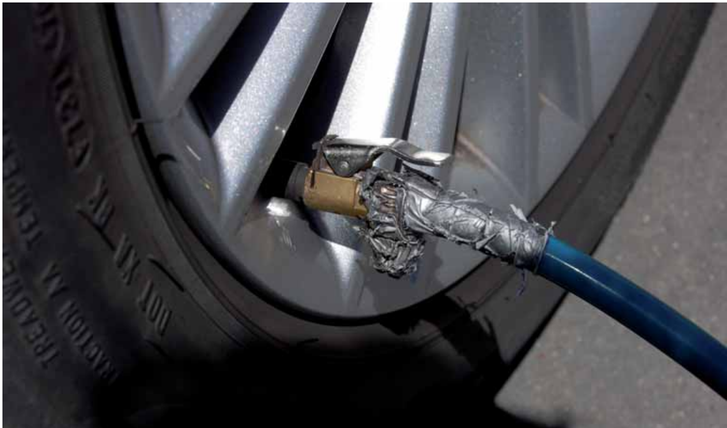
ASÍ ES. Muchos manómetros de uso público se encuentran en lamentables condiciones, como se aprecia en la foto.
