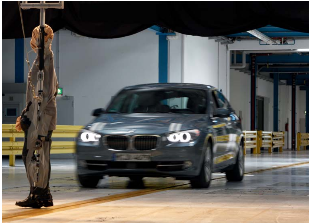
En las pruebas de choque también se comprueba las lesiones que se producen en caso de atropello.
