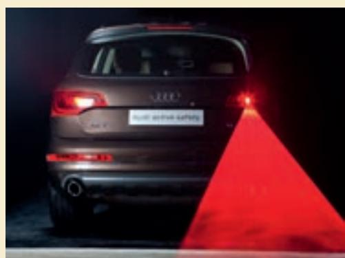
Cuando hay niebla o salpicaduras por lluvia, la línea se transforma en un triángulo. Aseguran que, de esta forma, además de mejorar la visibilidad, tiene el mismo efecto que un triángulo de advertencia.
