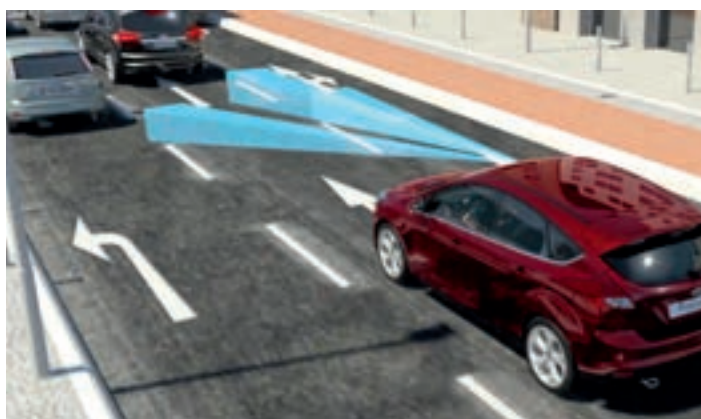
El frenado de emergencia calcula la probabilidad de colisión.
