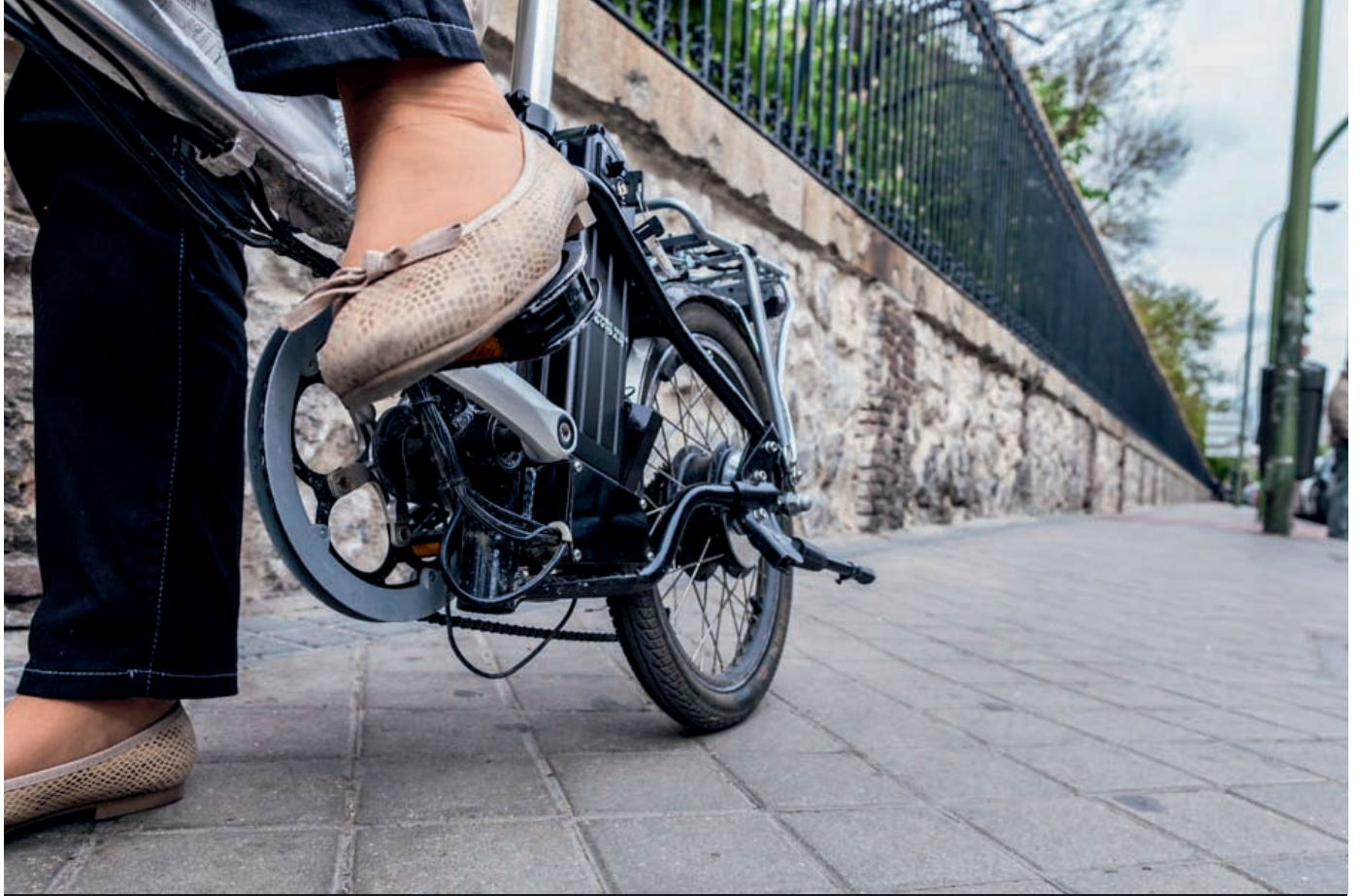
El motor incorporado 'multiplica' la fuerza de pedaleo del ciclista.
