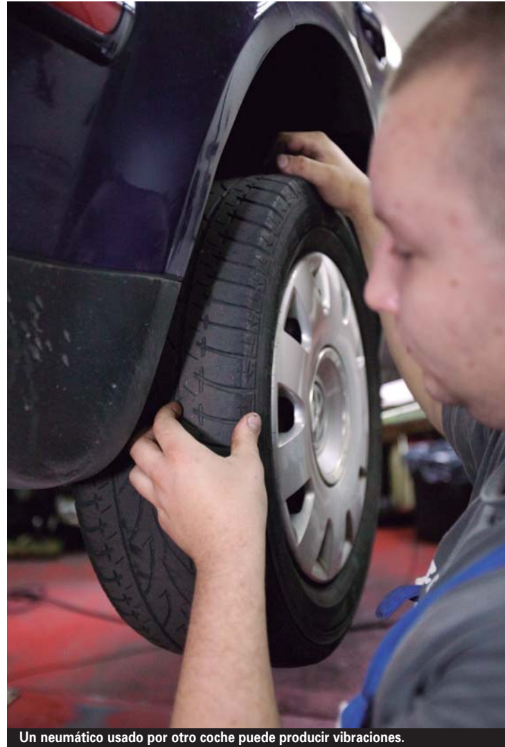
Un neumático usado por otro coche puede producir vibraciones.
