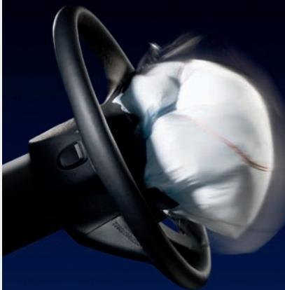
En resumen, el airbag es un componente desarrollado en base a las más avanzadas tecnologías en materiales ("saco", tapa), pirotecnia (generador), electrónica (ECU), simulación dinámica (para la puesta a punto en cada modelo de vehículo) e instrumentación y ensayos (catapulta e impacto de vehículo completo). Sin el airbag no es posible alcanzar los niveles de protección más elevados en las diferentes pruebas de impacto (EuroNCAP), ya que es un elemento necesario, como complemen-
