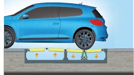
Al terminar el paso del automóvil, el mecanismo se encuentra en la posición original
