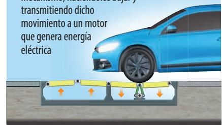
Al avanzar hasta la siguiente plataforma, los pivotes vuelven a elevarse hasta su posición original, obteniéndose más movimiento
