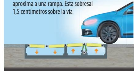
El eje delantero pasa sobre los pivotes del mecanismo, haciéndolos bajar y transmitiendo dicho movimiento a un motor que genera energía eléctrica
