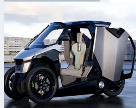
**TRICICLO HÍBRIDO.** Peugeot ha presentado un triciclo híbrido (dos motores eléctricos y uno de gasolina), destinado a desplazamientos urbanos. Funciona en modo eléctrico hasta los 70 km/h.
