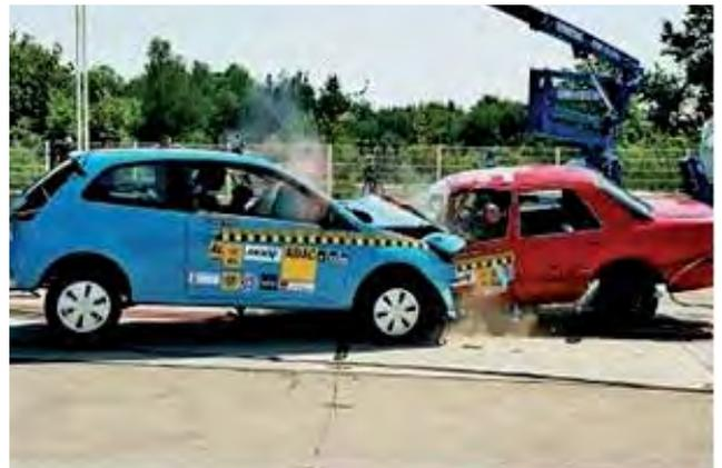
El objetivo tiene que ser que ambos vehículos se protejan respectivamente con una especie de "coraza" y que la energía del impacto se reduzca en la zona de absorción del impacto. Si, adicionalmente, la energía del impacto puede reducirse en la zona de absorción del impacto, será posible mantener lo más bajo posible el riesgo traumático para todos los pasajeros.
