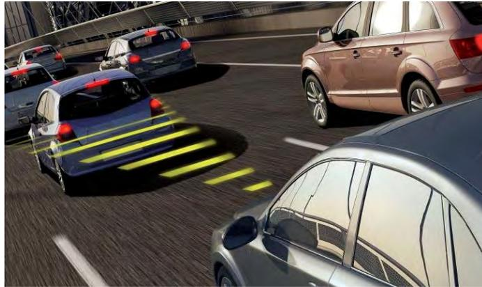
El control de la distancia de seguridad registra la situación que se produce delante del vehículo con la ayuda de un sensor de radar que calcula la distancia y la velocidad relativa hacia los vehículos que circulan por delante. Con el fin de adaptar la velocidad a la situación actual, el sistema de control de la velocidad y de la distancia de seguridad envía automáticamente órdenes al sistema de gestión del motor y/o – en combinación con el ESP – al sistema de frenos del vehículo.
