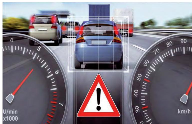
El momento de los avisos está calculado en función de la distancia de frenada y del tiempo de reacción del conductor. También tiene en cuenta las posibles acciones del conductor (p. ej. frenar o maniobrar) y si no hay señales de reacción por su parte, entonces el sistema le avisará antes.
