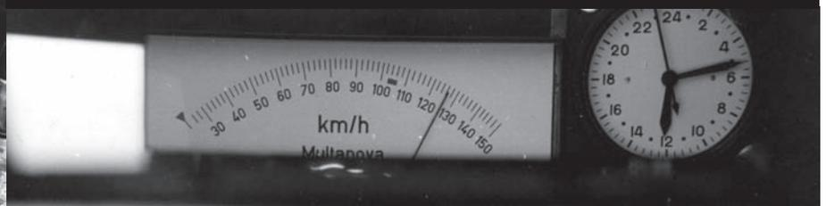
Las fotos de radar en la década de los 70 incluían la velocidad y la hora de la infracción.
