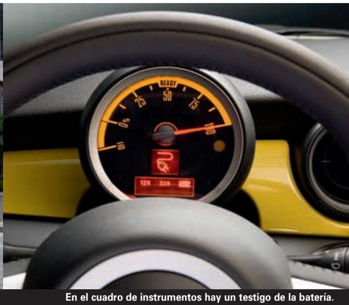
En el cuadro de instrumentos hay un testigo de la batería.
