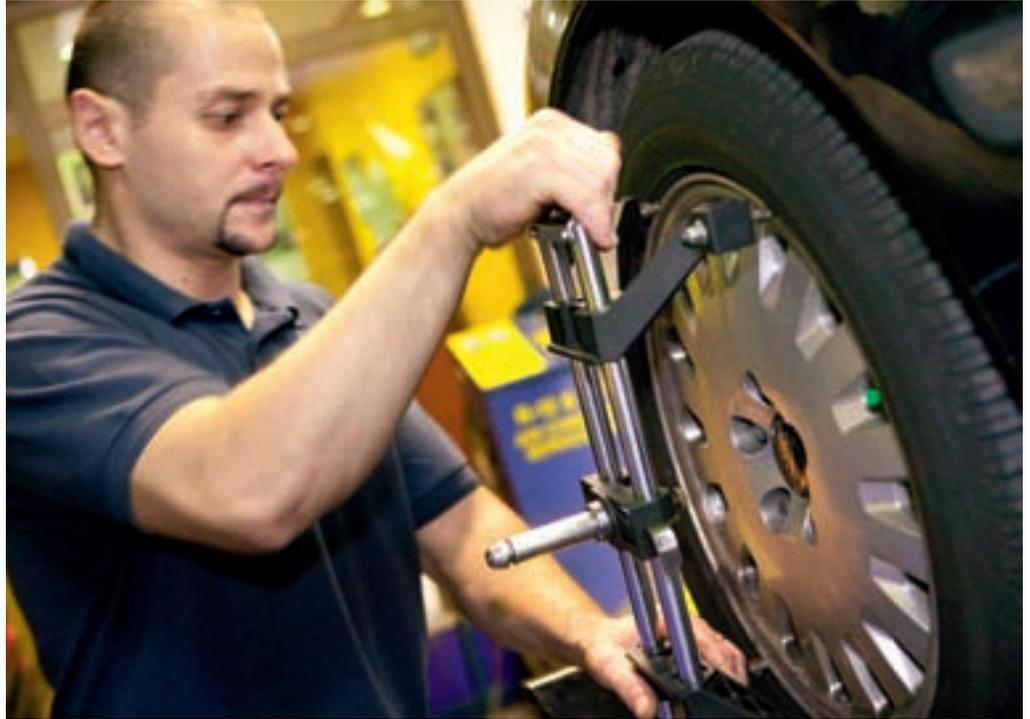
**DIRECCIÓN.** Porque es el elemento para dirigir el coche, es fundamental controlar su estado. Y más si ha notado ruidos, dureza anormal al girar, vibraciones, holguras o, incluso, un desgaste irregular de los neumáticos.
