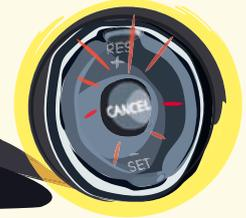
El conductor puede desconectar el ISA mediante una tecla o al pisar el acelerador con más fuerza.
