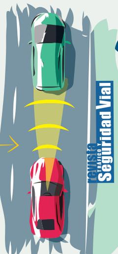
3 Sensores de radar y ultrasonidos, miden la distancia con el coche que le precede en base a la distancia seleccionada por el conductor, hasta 5 niveles según la marca y el modelo que lo utiliza.
