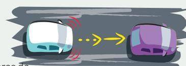
4 Adapta automáticamente la velocidad al tráfico, frenando y acelerando de manera autónoma.
