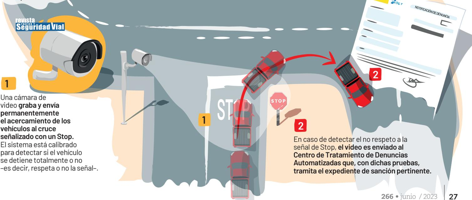
**1** Una cámara de video **graba y envía permanentemente el acercamiento de los vehículos al cruce señalizado con un Stop.** El sistema está calibrado para detectar si el vehículo se detiene totalmente o no –es decir, respeta o no la señal–.
