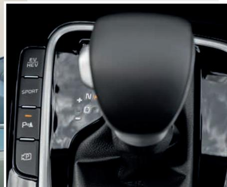
El asistente de aparcamiento suele funcionar por debajo de 30 km/h y a no más de 1,5 metros de distancia de la fila de coches ya aparcados.
