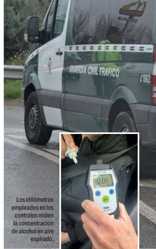
Los etilómetros empleados en los controles miden la concentración de alcohol en aire espirado.
