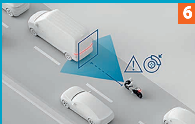
ABE Automatic Emergency Braking. Frenado automático de emergencia. A menudo se instala junto al FCW, para evitar colisiones.
