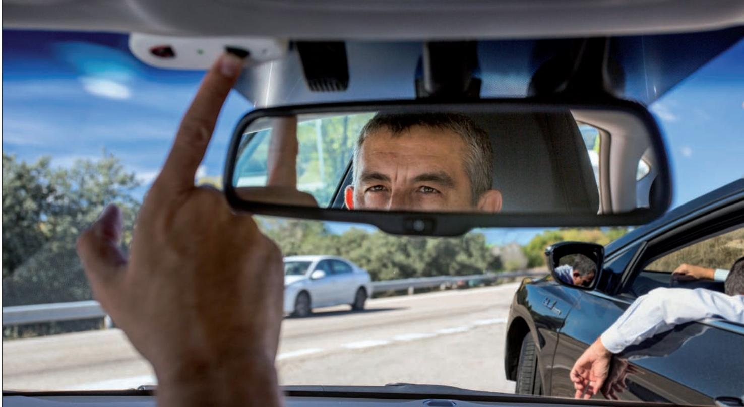
Además de la llamada de emergencia automática, el sistema eCall se podrá activar manualmente para avisar de un accidente que han sufrido otros.
