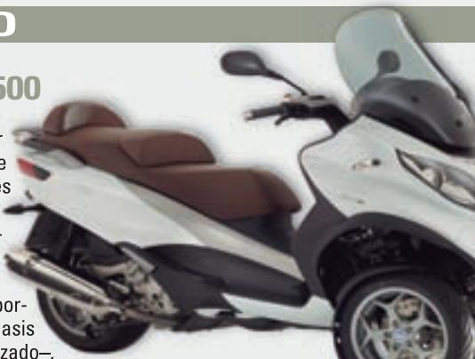
–antes, 12– y discos de freno de mayor diámetro. En el apartado de electrónica se equipa con un sistema de control de tracción ASR, para evitar que el scooter derrapse en aceleraciones –sobre todo cuando el asfalto tiene poca adherencia; por ejemplo, cuando está mojado– lo que es un añadido extra de seguridad. Otro extra importante es el ABS en el sistema de frenado, siendo el primero de tres ruedas de Piaggio que lo incorpora.
