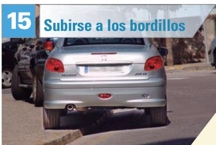
**Pérdida de aire, riesgo de "llantazo" y deformaciones que alteran peligrosamente la geometría de la dirección.**
