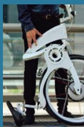
construida de aluminio y alcanza una velocidad de 25 km/hora cuando funciona su motor eléctrico, capaz de ofrecer autonomía de 60 km. Lo mejor es que pasa de 170 a 90 cm de longitud en solo un segundo.
