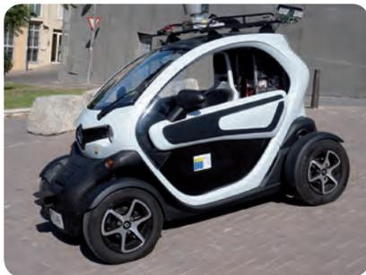
Pedro Javier Navarro, responsable del Laboratorio de Vehículos Inteligentes de la UPCT. Para ello se utiliza un coche, denominado Cloud Incubator Car (CICar), dotado de sensores láser 2D y 3D, radares, cámaras, sistemas inerciales, etc. Además de la información que suministran estos sistemas, se capturan datos biométricos
