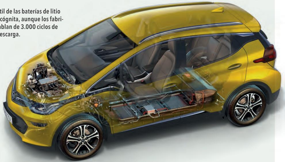
culos de calle. En este tipo de baterías se engloban diferentes tipologías, químicas y construcciones. Además del litio, pueden tener también hierro, manganeso, cobalto, cinc, etc. Tienen forma cilíndrica –muy parecidas a las pilas alcalinas convencionales– o fina y plana, como un sobre. Su principal ventaja es que son capaces de almacenar mucha mayor cantidad de energía ocupando menor espacio y siendo más ligeras que el resto de tecnologías actuales. Estos son
