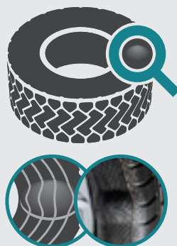
Abultamiento en los flancos del neumático
