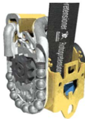
Figura 40. Esquema de funcionamiento del sistema de airbag y representación del pretensor pirotécnico de un cinturón de seguridad.
