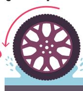
Si el neumático no es capaz de desalojar el agua de la carretera (por falta de dibujo, baja presión o velocidad inadecuada) se produce acuaplanin
