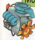
Vigilancia del nivel del aceite, reponiéndolo si es necesario. Si no se tiene la misma marca de aceite, se puede cambiar de marca, pero teniendo en cuenta que nunca se puede mezclar un «aceite detergente» o HD, con uno que no lo sea. Para aquellos vehículos que vayan provistos de manómetros comprobar con el coche en marcha la presión del aceite, ésta debe estar entre 2 y 4,2 kg/cm.<sup>2</sup> o atmósferas.
