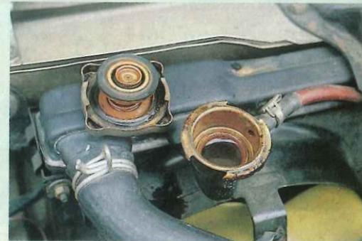
El óxido en el tapón del radiador puede impedir la comunicación con el depósito de expansión.
