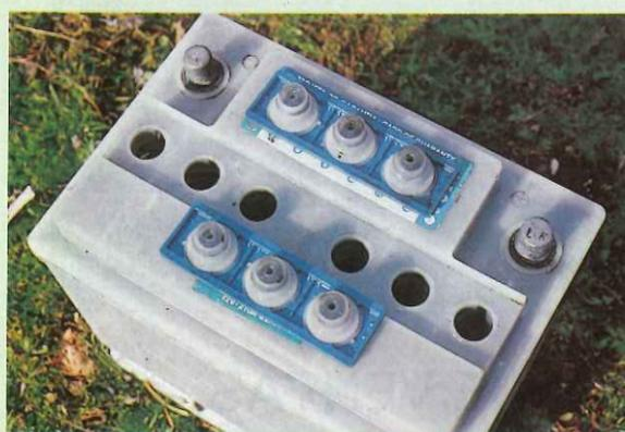
Las baterías deben rellenarse solamente con agua destilada y sin hacerlo en exceso para evitar que se pierda electrolito. Los tapones cuentan con un orificio para dar salida a los gases. Dado que es fácil que éstos arrastren pequeñas cantidades de electrolito, es necesario limpiarlos.
