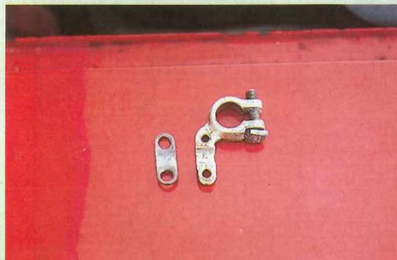
El terminal metálico de los cables del automóvil, que suele ser el polo positivo —aunque en muchos vehículos ingleses es el negativo—, es el elemento que más se corroe y desgasta. Un lijado fino no es suficiente. Es necesario arrancar sus incrustaciones y dejarlo perfectamente limpio. Su capacidad conductora mejora de esta forma enormemente.
