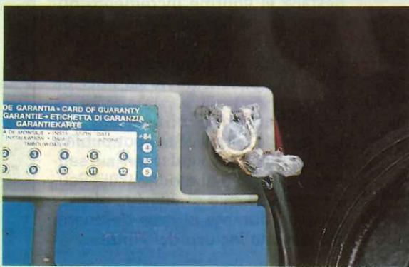
La operación de recubrir los terminales con un producto aislante no es imprescindible, pero sí útil. Al hacerlo evitamos el contacto con el aire y, lo que es más importante, con el vapor de agua que éste contiene. En las zonas marinas esta atmósfera húmeda es aún más corrosiva.
