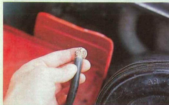
Aparte del mejor aspecto que tendrá el soporte después de limpio y pintado, y de que durará muchísimo más, la batería funcionará en mejores condiciones por el carácter aislante de la pintura. Por otra parte, dejar la chapa oxidada significa el rápido fin de la misma. Respecto a los cables de conducción, igualmente los limpiaremos con meticulosidad.
