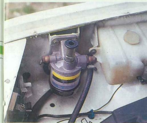
Los filtros de gas-oil tienen una especial importancia para este tipo de motores. En el mismo mecanismo, además de un buen filtro, se suele situar un pequeño depósito para que se deposite el agua que pueda incorporar el combustible o haya entrado en el depósito por cualquier circunstancia.
