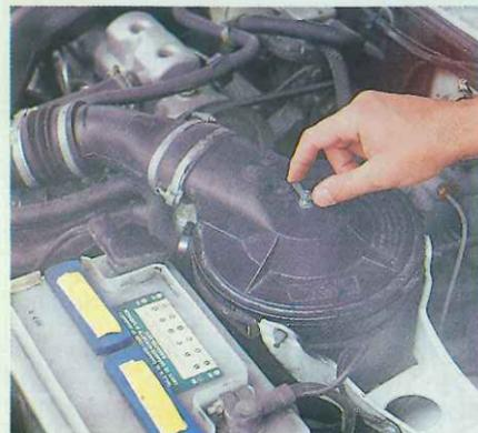
Los filtros del aire se encuentran colocados de forma particularmente accesible para que todo usuario pueda sustituirlos sin ninguna ayuda especial. Incluso es fácil encontrarlos con que ni siquiera es necesario el uso de un destornillador.
