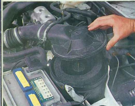
Para acceder a los filtros de aire, normalmente no es necesario desconectar los tubos de admisión de aire. Con lo único que es preciso tener cuidado es con la entrada de aire al carburador. Una vez retirado el filtro viejo, es conveniente realizar una limpieza en la carcasa.
