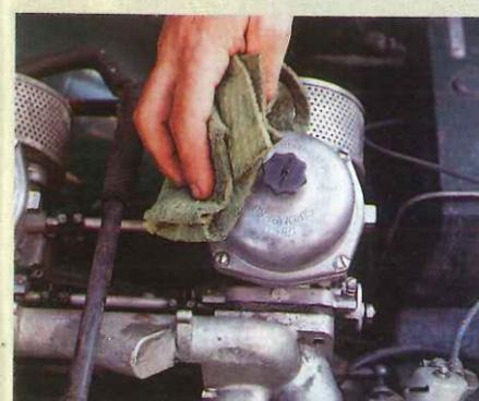
*No está de más que en cualquier caso se proceda a un repaso final con un trapo seco, e incluso que, provistos de aceitera o engrasador, repasemos la lubricación de las articulaciones del carburador, embrague, etc.*
