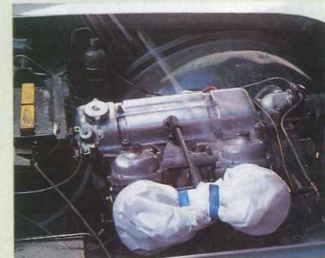
*Una recomendación siempre útil es la de proteger contra la entrada de agua las tomas del filtro de aire y las partes eléctricas más sensibles. Para esto puede servirnos cualquier bolsa de plástico que tengamos a mano y nos evitaremos con ello problemas de arranque con el motor limpio, pero húmedo.*
