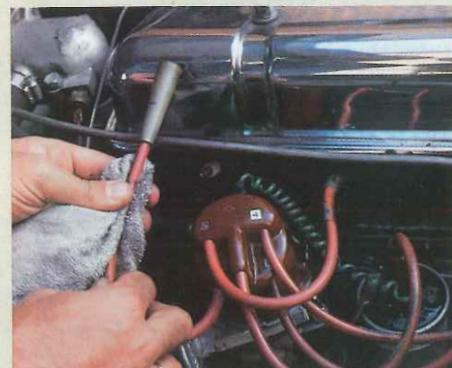
*La tapa del Delco y los cables de bujías y de bobina (o los del sistema electrónico) es conveniente limpiarlos con meticulosidad y de uno en uno. Una vez limpios, pueden protegerse con vaselina en spray o con algún otro producto similar que no contenga disolventes.*
