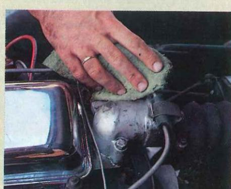
*Una última medida antes de cerrar el capó puede consistir en secar con un trapo todos los manguitos, conducciones, cables, etc., para eliminar de los mismos los restos de jabón o de disolvente que pudieran quedarse adheridos después del lavado.*
