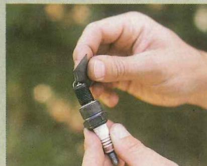
La extracción de las bujías es más sencilla si se realiza con el motor caliente. La limpieza con una lija fina, después de dejar que se enfríe, puede resolver muchas situaciones fastidiosas y permitimos rodar un buen montón de kilómetros.
