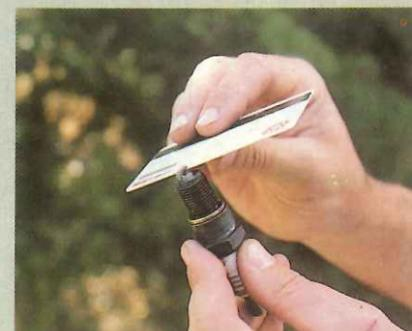
Los parches porosos tienen una duración limitada. Si la bujía está mal, lo mejor es cambiarla. La separación de electrodos vendrá especificada en el libro del coche, pero, a falta de medidas, puede servirnos una tarjeta de crédito que quede muy ajustada entre los electrodos.
