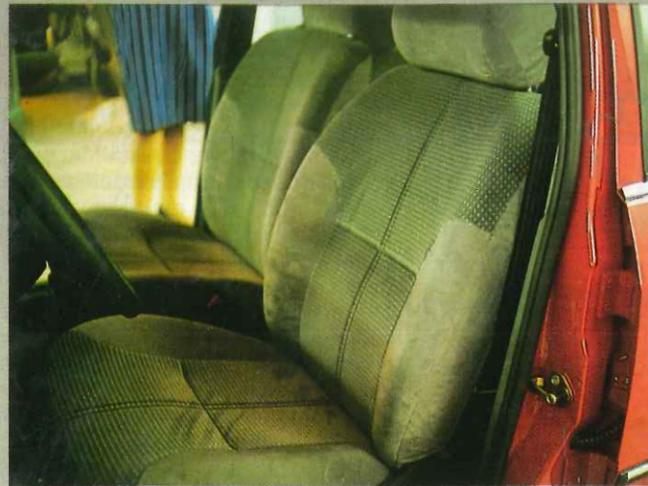
Los asientos no pueden ser demasiado deformables, pues comprometerían la comodidad y estabilidad del ocupante.
