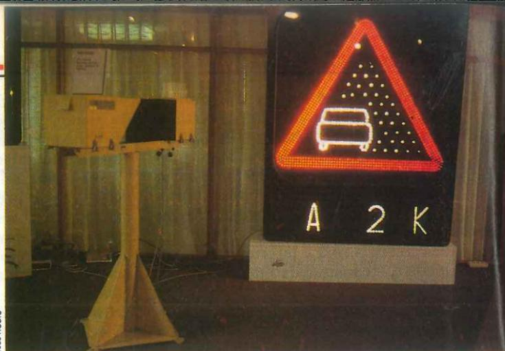
Visibilímetro que analiza la intensidad de la niebla y activa las señales de limitación de velocidad en función de la velocidad de parada (foto tomada en la II Expo Tráfico de Gijón).
