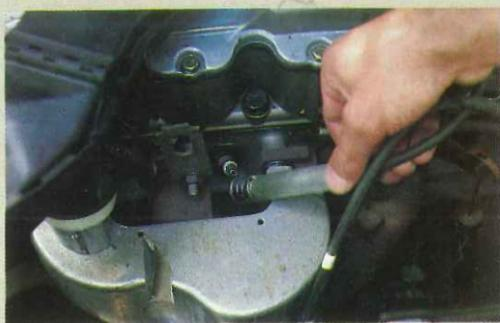
Es interesante y puede evitarnos posteriores complicaciones proceder a numerar los cables a medida que los vamos retirando. Esta numeración puede ser absolutamente convencional, pero a efectos de cambio de bujías, limpieza, etc., es muy útil.
