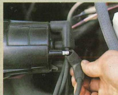
En ocasiones se achacan a las bujías fallos eléctricos que puede ser originados por un mal contacto, un cable agrietado o la acumulación de suciedad. En una revisión de bujías debemos igualmente acordarnos de los contactos.
