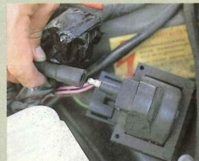
En los encendidos electrónicos, el funcionamiento de todo el sistema suele ser más seguro y los fallos menos frecuentes. De todas formas, la humedad, el óxido y la suciedad les afectan como a cualquier otro.
