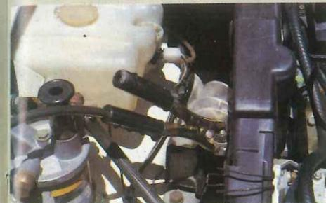
El segundo cable en conectar es el de los terminales negativos (siempre identificado en negro, al igual que el positivo en rojo), se conecta en primer lugar el negativo en el terminal de la batería auxiliar y el otro terminal en un punto de la masa del vehículo que se encuentra con la batería descargada. Se puede conectar también al terminal negativo de la batería descargada.
