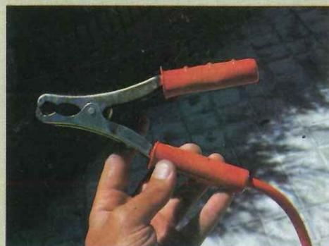
Los cables deben encontrarse en buen estado, tienen que ser de un grosor suficiente para que no se calienten y las conexiones en las pinzas estar bien hechas. De paso, conviene que el aislamiento de pinzas y cables no tenga roturas y se encuentre bien colocado.
