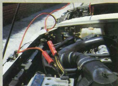
En primer lugar se conectan los positivos de ambas baterías comenzando por el de la batería descargada. Esta es una norma que no siempre se sigue, pero que tiene una gran importancia para la seguridad de las propias baterías y para evitar descargas inesperadas.
