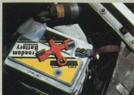
Antes de realizar las conexiones se debe examinar el estado de los terminales de la batería, y si es necesario hacer una pequeña limpieza de los mismos. Si la parada ha tenido lugar con el motor caliente y en buenas condiciones, se puede no desconectar los terminales de la batería auxiliar. Si la descarga es total y el propio motor está frío, sí conviene realizar la operación anterior.
