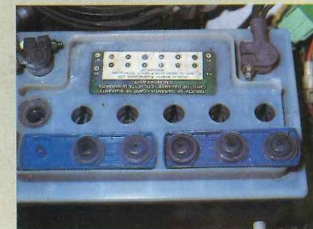
Antes de conectar el cargador es imprescindible quitar los tapones a la batería. Durante el proceso de carga se producen pequeñas cantidades de gas hidrógeno que tienen que salir al exterior. Este hidrógeno no es muy peligroso, por lo poco que se produce, pero conviene recordar que éste es un gas sumamente inflamable y tomar las precauciones normales.
