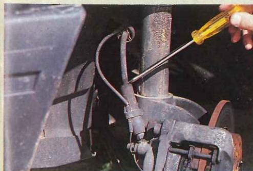
Para hacer que sean elásticos los manguitos de conducción del líquido de frenos, se suelen fabricar de goma. Además de que ésta envejece y se agrieta, conviene revisar las uniones con la pinza y el resto del circuito, ya que éstos son los puntos más débiles.
