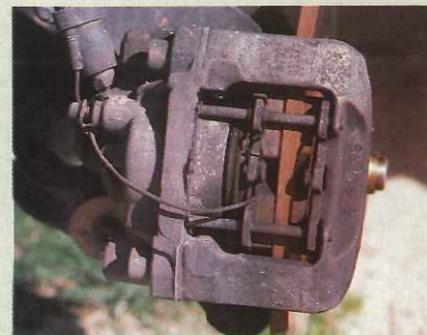
Prácticamente en todos los frenos de disco se puede comprobar visualmente, y después de haber quitado la rueda, el desgaste de las pastillas. Una pastilla nueva viene a tener un centímetro de espesor de ferodo y con menos de 3 milímetros estaremos en situación de alerta.
