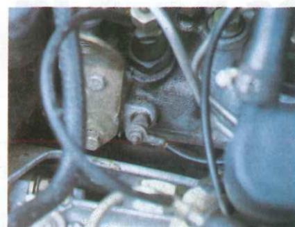
Los calentadores, en los motores diesel que cuentan con ellos, son imprescindibles para el buen arranque. Si un motor de gas-oil no arranca bien en invierno, lo primero a revisar son estos elementos.
