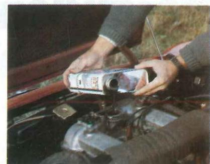
Atención a los arranques en frío y a la viscosidad del aceite. La mayor parte del desgaste interno del motor se produce en el primer minuto de funcionamiento del mismo.
