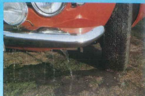
La llegada del invierno es el momento adecuado para efectuar un vaciado del radiador y cambio de refrigerante. Para realizar esta operación se puede utilizar el grifo de vaciado con que cuentan muchos modelos o simplemente retirar uno de los manguitos inferiores. Lo que sea más fácilmente accesible.
