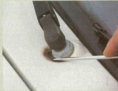
En los rincones escondidos y pliegues de la carrocería, el agua se acumula y tarda mucho tiempo en desaparecer, acelerando la oxidación. En estos puntos la suciedad no actúa como protector, como ingenuamente piensan algunos, sino como acelerador, ya que retiene la humedad y prolonga en el tiempo la acción de la misma.
