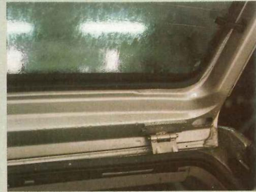
El óxido sobre la chapa aparece en primer lugar en las juntas, en los puntos de unión y soldadura, y sobre todo, allí donde la pintura acaba, sea un cristal, sea una junta, etcétera. En estos puntos de discontinuidad cambian las condiciones ideales de protección previstas por los fabricantes.
