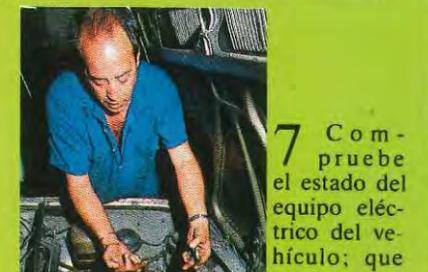
**7** Compruebe el estado del equipo eléctrico del vehículo; que no haya cables pelados ni quemados y el estado de sulfatado de la batería.
