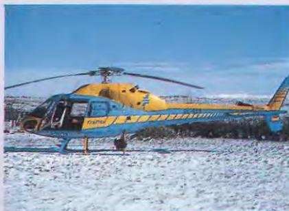
avanzadas características técnicas. Se trata de aparatos con una autonomía de vuelo de casi cuatro horas, cuya velocidad máxima puede alcanzar los 272 km/h., mientras que la de crucero está en los 230 km/h. La altura máxima a la que pueden volar es de unos 4.500 m. y su capacidad es de seis personas, tripulación incluida.
