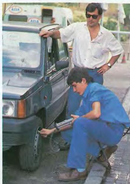
La falsedad de la medida que proporcionan el 76 por 100 de los manómetros se acentuará si hace la verificación con los neumáticos calientes.
