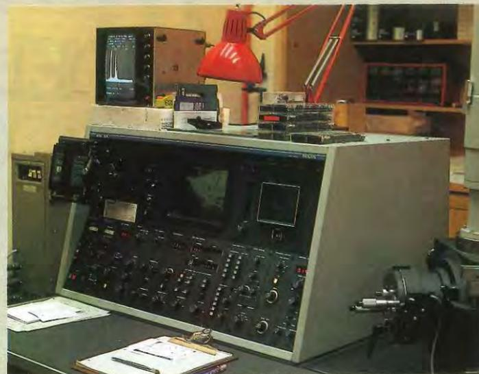
Panel de un microscopio electrónico, trabajando en la búsqueda de restos de plomo en las paredes de los cilindros.
