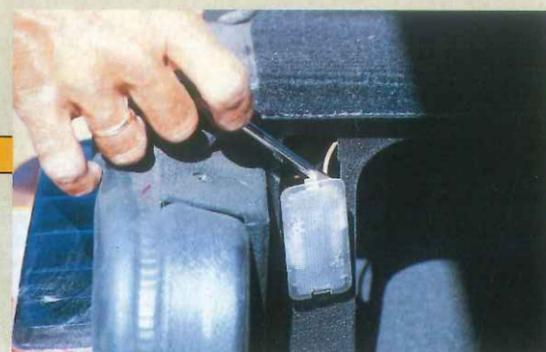
**E**STAS luces suelen encajarse a presión mediante un clip, fácil de soltar, pero la operación se debe realizar con cierta prudencia para no forzar y dañar el plástico de la tulipa.
