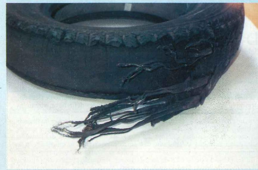
Estado en que quedó un neumático usado después de someterlo a las mismas condiciones que uno nuevo.
