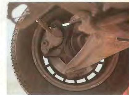
Por su importancia, conviene comprobar el estado de desgaste de las pastillas de los frenos. Algunos vehículos incorporan un dispositivo de aviso de un desgaste excesivo, mediante un indicador luminoso en el tablero de mandos. Pero, en todo caso, conviene realizar una revisión cada 25.000 kilómetros, que suele ser el tiempo máximo de duración de las pastillas.
