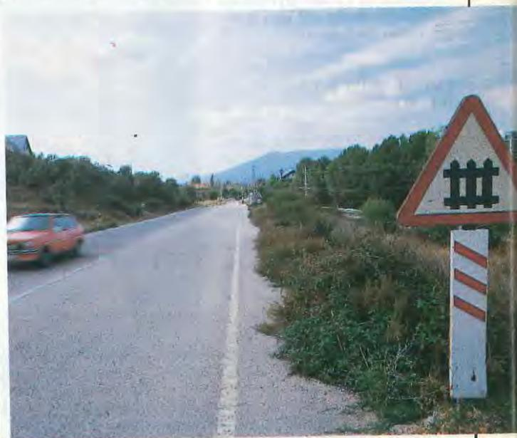
de que, en el anexo 5 del Código, el ejemplo que figura recoge solamente una de las dos posibilidades de cada caso. Quede claro que la señal de paso a nivel con o sin barreras tanto puede estar incorporada a un panel con las barreras inclinadas de izquierda a derecha como de derecha a izquierda. En todo caso, la inclinación debe ser siempre hacia el centro de la calzada.
