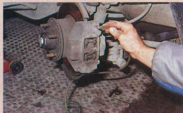
**L**os purgadores se aflojan normalmente con una llave del 9 ó 10. Para realizar el purgado son necesarias dos personas: una que manipule el purgador y otra que actúe sobre el pedal del freno. En primer lugar, se pisa el freno hasta el fondo; en ese momento se afloja el purgador y se deja salir el aire mezclado con el líquido.
