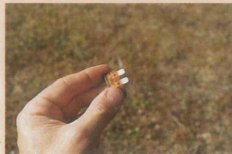
**S**i el fusible está fundido, normalmente habrá dejado de funcionar algún otro aparato que trabaje controlado por el mismo fusible que los intermitentes y esto nos puede servir para determinar que es el fusible el que está mal.
