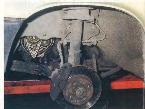
**AMORTIGUADORES.**—La vida útil de un amortiguador se sitúa en torno a los 40.000 kilómetros, pero si ha notado molestias de estabilidad, lleve inmediatamente el coche al taller. Allí le harán una inspección más a fondo y le sustituirán, caso de ser necesario, este elemento. La amortiguación no sólo es responsable de la comodidad de la marcha, sino que de ella depende, y más cuando el vehículo circula a plena carga, la estabilidad del mismo.
