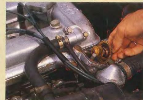
**E**n ocasiones el termostato se sitúa al final de un manguito, pero en otras se coloca en un compartimento especial, cuya tapa tiene una junta para que no se produzcan pérdidas. Es necesario tener mucho cuidado para no romper esta junta.
