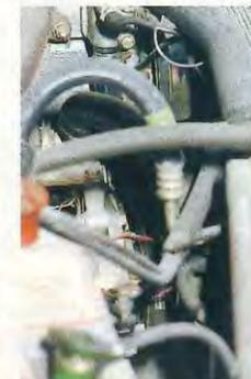
su estado, ya que podrían haberse «picado» o haberse aflojado las abrazaderas. En caso de encontrarlos deteriorados, sustituirlos rápidamente, pues podrían dar lugar a pérdidas de líquidos y a deficiencias en la refrigeración del motor («calentón») o frenada.
