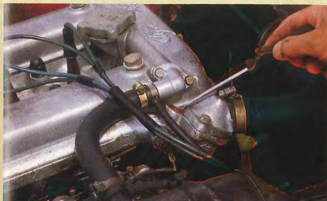
**E**n muchas ocasiones simplemente un purgado del circuito nos soluciona un problema de calentamiento. Si en el circuito hay burbujas, la bomba puede funcionar mal, así que purgar y comprobar que no hay aire es una operación sumamente interesante.
