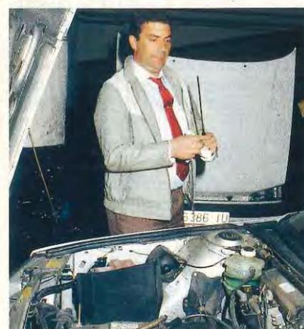
**NIVEL DEL ACEITE.**—Busque la tarjeta donde apuntó el último cambio de aceite hecho al coche. Los fabricantes recomiendan, como término medio, la sustitución del aceite del motor cada 5.000 kilómetros. Cámbielo si los ha sobrepasado o si, con la previsión de kilómetros a realizar durante el viaje, va a
