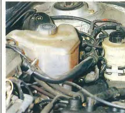
**NIVEL DEL LIQUIDO DE FRE-NOS.**—Como quiera que la presión del pie al frenar se transmite a través de un líquido, de la correcta cantidad de éste dependerá la efectividad de la frenada. La comprobación es también muy sencilla y basta con cerciorarse de que el depósito de este elemento tiene el nivel de líquido entre las marcas de máximo y mínimo.
