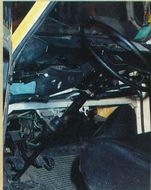
La columna de la dirección, sobre todo en los modelos más antiguos, puede ser desplazada en un choque frontal y herir al conductor.
