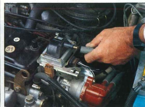
El invierno y la humedad son muy agresivos con todo el sistema eléctrico y en las conexiones aumenta la oxidación y el deterioro de las mismas.
