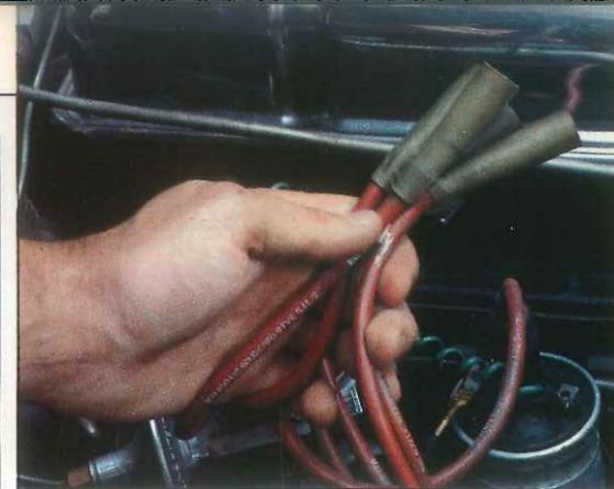
La humedad propicia las fugas de corriente en el circuito de alta tensión. Conviene revisar el cableado y mantenerlo limpio.
