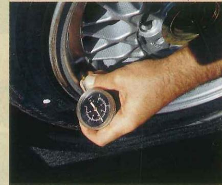
**C**UANDO se comprueba la presión de inflado, es muy importante que las ruedas de ambas bandas estén a la misma presión, que debe, en principio, ser la que recomienda el fabricante del vehículo. Sin una buena experiencia no se debe jugar con las presiones de los neumáticos, que alteran las condiciones de rodadura.
