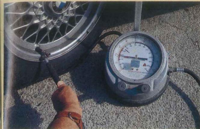
**E**N todas las estaciones de servicio existe un punto de toma de aire a presión para inflar los neumáticos. Su uso suele ser gratuito y de suma sencillez, pero conviene tener presente que sus manómetros no siempre funcionan muy correctamente.
