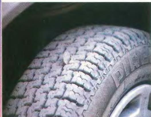
El dibujo de un neumático debe ser suficientemente profundo para evacuar el agua que pisa.
