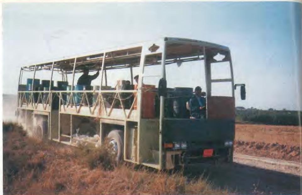
Pruebas de resistencia de un prototipo de Hispanocarrocera sobre terreno accidentado.
