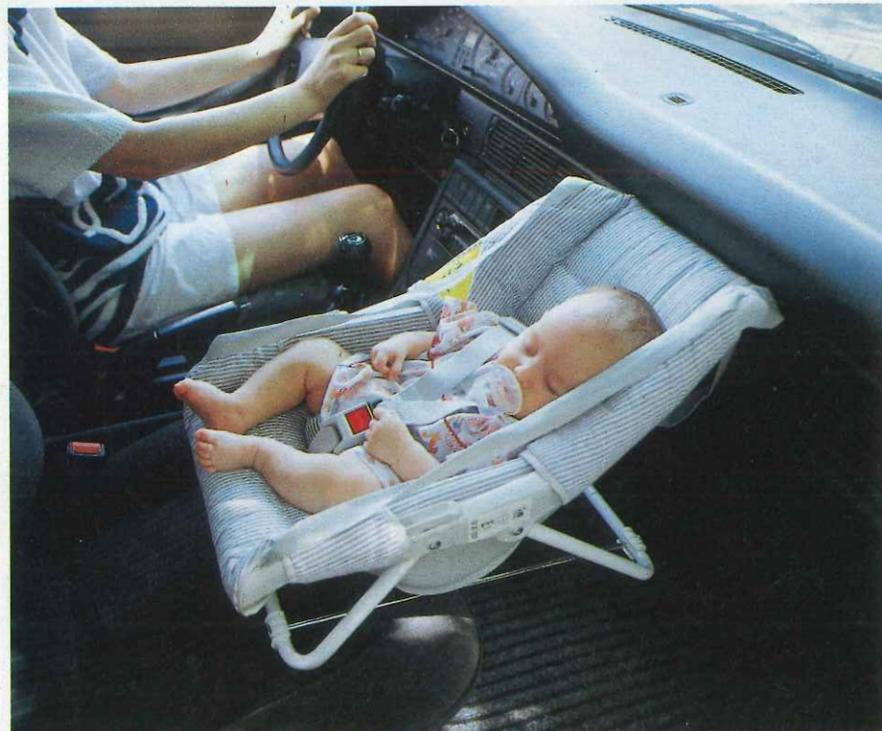
No es suficiente con colocar la silla sobre el asiento. Es fundamental que vaya sujeta a la estructura del vehículo.
