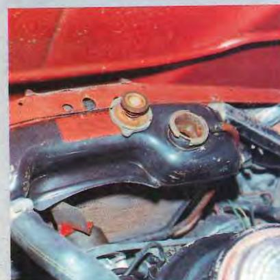
**E**S fundamental vaciar el sistema de refrigeración: el agua es un agente importante en la oxidación y el radiador se puede estropear.
