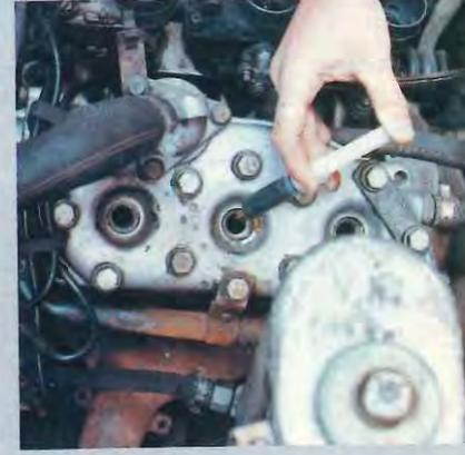
**E**N caso de no contar con un aceite de elevada untuosidad especial para invierno, podemos cebar los cilindros por el orificio de las bujías.
