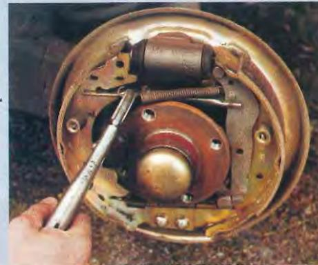
UNA vez descubiertas las zapatas y bombines, conviene hacer una revisión visual de los mismos, para comprobar que no tienen la menor fuga; luego, nos aplicamos al fuerte muelle que une las zapatas.
