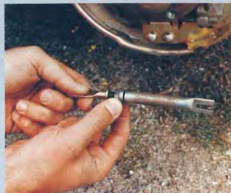
Las zapatas en este modelo contaban con un sistema de ajuste que es necesario poner a punto al colocar unas nuevas con mayor espesor. Esto ocurre, igualmente, en casi todos los frenos de tambor.
