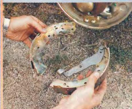
La operación de soltar las zapatas nos exigió algún esfuerzo y, sobre todo, fijarnos bien en cómo iban colocadas, para remontarlas de idéntica manera.
