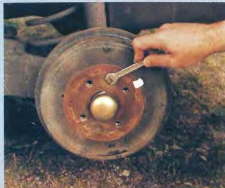
LOS tambores vienen sujetos normalmente por un simple tornillo al cubo de la rueda. En otros modelos pueden ser dos, pero siempre fáciles de ver, muy accesibles y normalmente muy fuertes.
